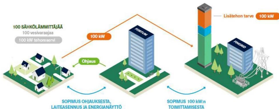
Kuva 1. Fortumin pilotti, jossa 100 kW:n kysyntäjoustopalvelu koostuu joukosta sähkölämmitteisiä koteja (Fortum 2016a).
